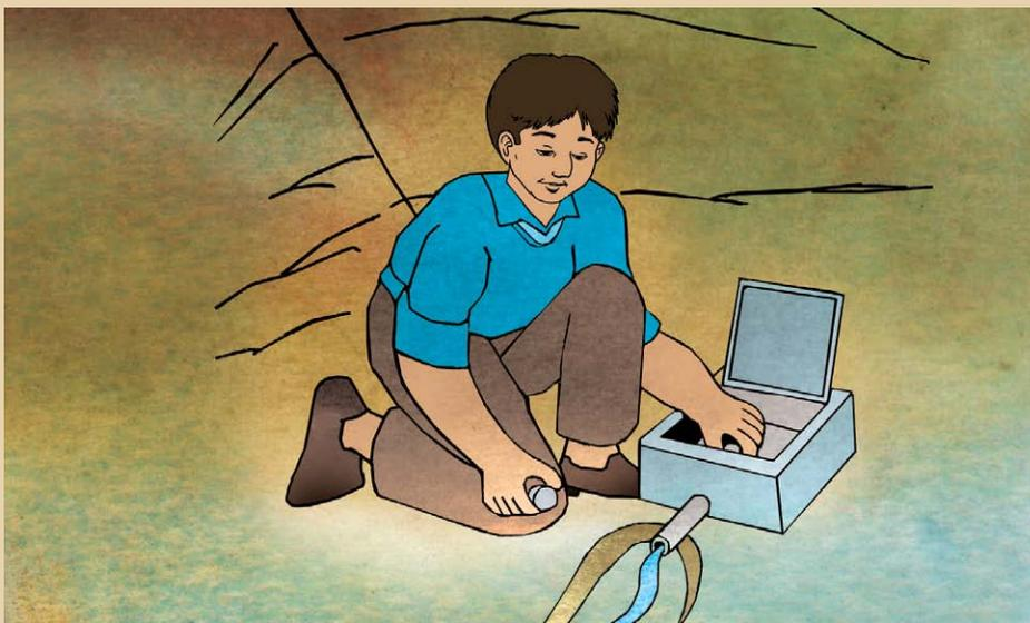
7. Dejar que el agua enjuague la red de tuberías antes de cerrar las válvulas de purga y los caños hasta que no se perciba el olor a cloro o cuando el cloro residual medido en el reservorio no sea mayor a 1.00 mg/lit.
