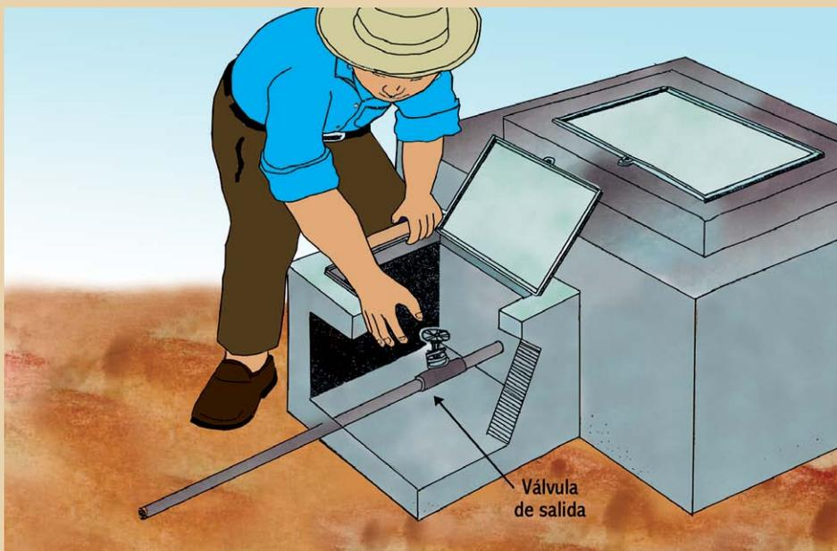
8. Dejar correr el agua por la línea de conducción durante 30 minutos y transcurrido este tiempo, volver a cerrar la válvula de salida y quitar el tubo de rebose para que el agua corra y elimine los restos de cloro.
